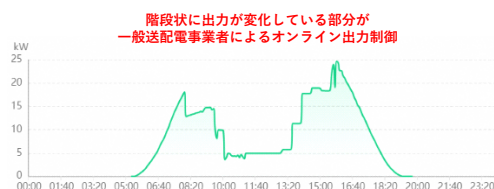
図 5：オンライン出力制御が行われた太陽光発電所の発電実績例
