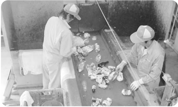
福江リサイクルセンターの資源ごみ手選別作業
