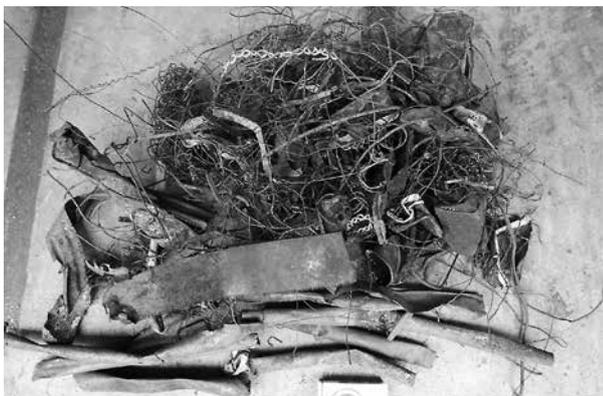
福江地区で回収した可燃（燃やす）ごみは、福江清掃センターで焼却処理をしています。集められたごみは途中で引っかかったり詰まったりしないように、焼却される前にごみ破砕機にかけられ小さくなって焼却炉へ送られます。近年、回収した可燃ごみの中に大型の金属棒やのこぎりの刃、針金などが大量に混入していて（16,600kg / H24年度）、ごみ破砕機の軸が折れ一時的に焼却処理を行えないという事態が発生しています。
