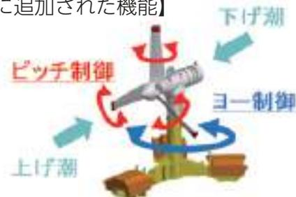
**ヨー制御**：潮の向き（上げ潮・下げ潮）により発電機の向きを可変させ効率的に発電するための制御
